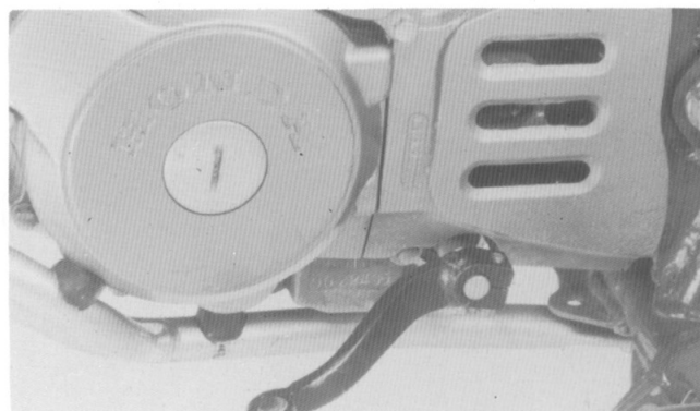
(2) O número de série do motor está gravado na parte inferior da carcaça esquerda do motor.
